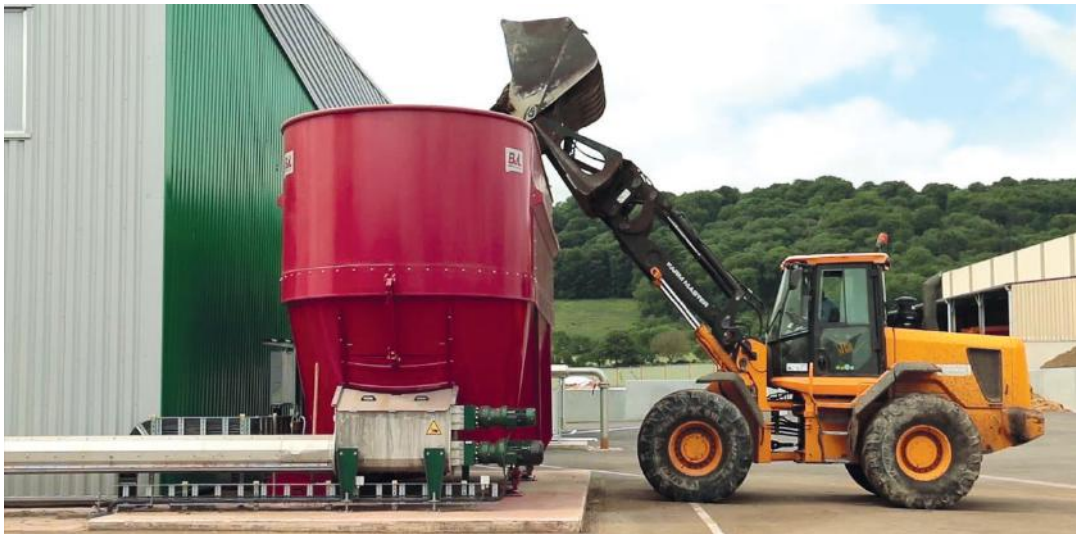
Incorporation de fumier dans une trémie.
